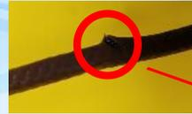
① 熱電対の被覆が破れた状態
