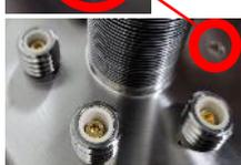
③ 内部のセンターセラミックリングのエッチ部分の数箇所にカケが確認
